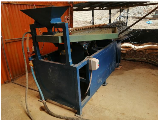
Mesa gravimétrica para recuperación de oro
